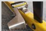
Bremse betätigt. Freno applicato. Brake applied. Frein serré.
